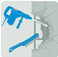
Удаление **рыхлого** и структурно **поврежденного** бетона, очистка арматуры от коррозии.
